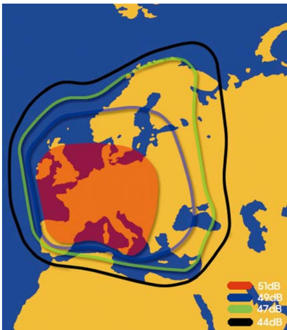
Copertura del satellite HOTBIRD
