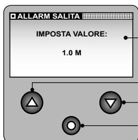
Se l'unità di misura impostata è METRI, i valori selezionabili sono: DISATTIVATO, 1.0M, 1.5M, 2.0M, 2.5M, 3.0M, 3.5M, 4.0M, 4.5M, 5.0M
