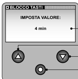
I valori selezionabili sono: DISATTIVATO, 1min, 2min, 3min, 4min, 5min, 6min, 7 min, 8min, 9min, 10min. (imp. di fabbrica: DISATTIVATO)
