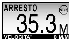
La precisione di lettura della velocità di movimento della catena è del  $\pm 1\%$ .
