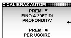
Questa finestra informativa indica che è necessario calare 6 metri di catena (o 20 piedi, a seconda dell'unità di misura selezionata) in maniera ininterrotta. In funzione del numero di giri compiuti dal barbotin (contati dallo strumento) si potrà calcolare la lunghezza di catena svolta ad ogni giro.
