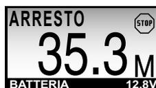
La precisione di lettura della tensione di alimentazione è del  $\pm 1\%$ .
