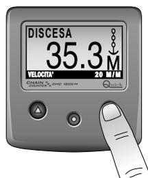
E' possibile calare l'ancora anche utilizzando un comando elettrico ausiliario; lo strumento conta catena misurerà comunque la lunghezza di catena calata.
