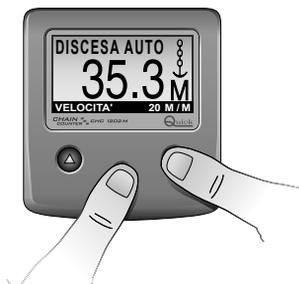
E' possibile interrompere la procedura di discesa automatica premendo un pulsante qualsiasi dello strumento da cui è stata attivata la procedura oppure attivando la salita da un comando esterno (da un'altro conta catena o da un comando ausiliario) oppure spegnendo lo strumento.
