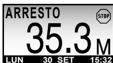
La data e l'ora sono mantenute anche a strumento spento (è dotato di batteria tampone).
