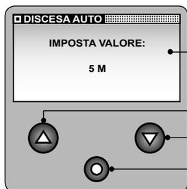
Se l'unità di misura impostata è METRI, i valori selezionabili sono: OFF, da 5M a 100M con passi 5M
