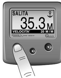
E' possibile salpare l'ancora anche utilizzando un comando elettrico ausiliario; lo strumento conta catena misurerà comunque la lunghezza di catena calata.
