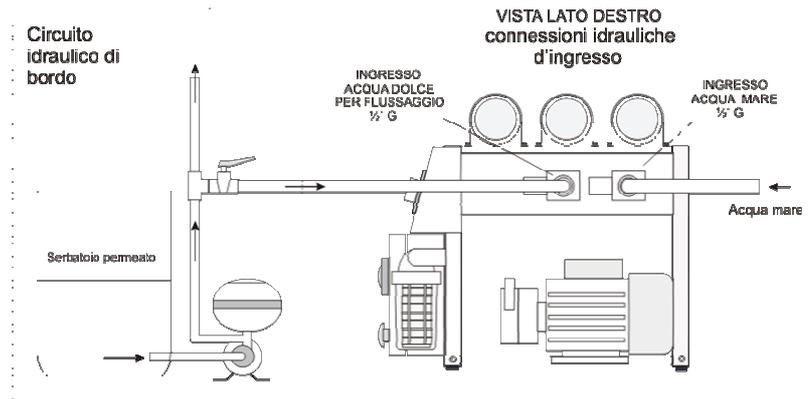
Collegare il raccordo di scarico (1/2" gas) a sinistra del dissalatore ad uno scarico a mare posto sopra la linea di galleggiamento.
