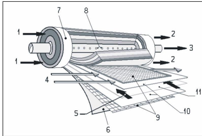
**Le membrane semipermeabili**, utilizzate nella produzione dei dissalatori BAITEK, sono costruite in materiale sintetico a struttura spiralata e confezionate in unità ben distinte definite **moduli**. Le membrane adatte a dissalare l'acqua di mare hanno una reiezione salina di oltre il 99% e posso operare fino ad una temperatura dell'acqua di 40°C.
