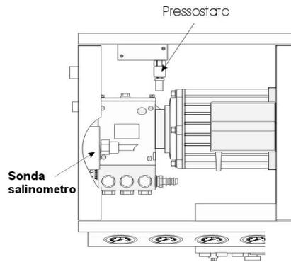
Ruotare la vite interna al pressostato, con un cacciavite a taglio, in senso orario (per incrementare), riportare il punto di intervento alla taratura originaria.
