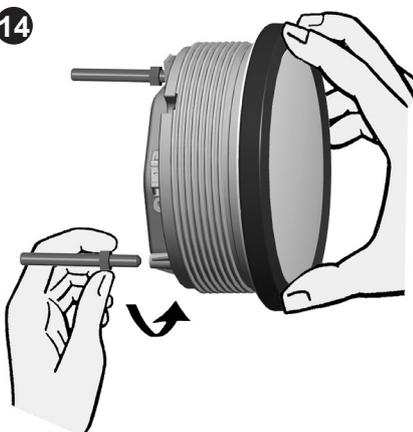
Se non si desidera utilizzare il dado di fissaggio si può applicare in alternativa il set di pezzi A2C59510854 una scelta consigliabile se la posizione dell'installazione è soggetta a forti oscillazioni.
