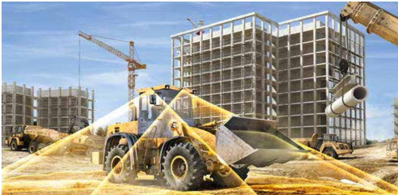
ProViu®360 è un sistema di visualizzazione surround digitale completo che utilizza telecamere con trasmissione digitale di immagini HD ad alta risoluzione.
