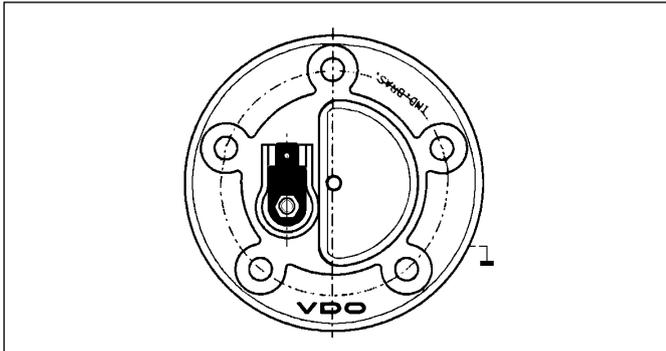
TERMINALE A LAMA PER USCITA, NO COLLEGAMENTO DI MASSA
