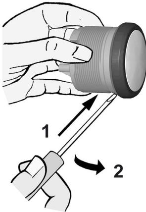
Per il montaggio a filo, cioè se la protezione in vetro e il pannello montati da dietro sono sullo stesso piano, è necessario smontare l'anello frontale. Con i due pollici premere la protezione in vetro e pressare contemporaneamente con i due indici l'anello frontale verso la parte anteriore dell'apparecchio. Se si utilizza un utensile seguire il disegno riportato accanto.
