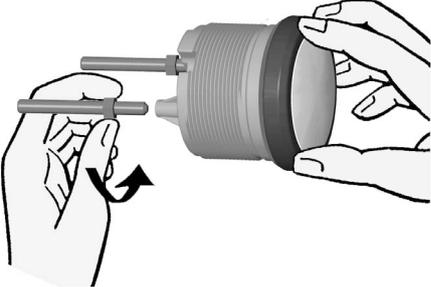
Se non si vuole utilizzare il dado di fissaggio si può applicare in alternativa il set di pezzi A2C59510854 che è consigliabile se il punto di montaggio è soggetto a forti oscillazioni.
