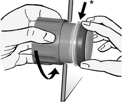
Orientare l'apparecchio e stringere saldamente il dado di fissaggio. Accertarsi che il dado non sia stretto con una coppia di serraggio superiore ai 400 Ncm.
