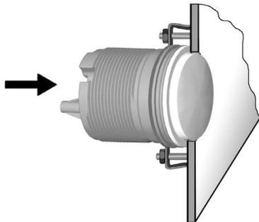
Inserire la guarnizione per il montaggio a filo A2C53215640 sulla protezione in vetro.
