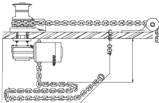
Le guindeau doit être placé où le puits à la chaîne a la profondeur maximum.
