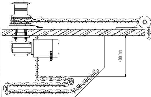
Wenn Sie die korrekte Position der Winde gefunden haben, bohren Sie unter Verwendung der beiliegenden Einbauschablone die notwendigen Löcher. Wie oben beschrieben, demontieren Sie die Winde und dichten Sie die Unterseite der Basis sowie die Stehbolzen mit einer hochwertigen Dichtmasse ein. Die Plazierung der Winde muß so erfolgen, daß die Kette frei und parallel zum Deck geführt ist und der Umschlingungswinkel der Kette auf der Kettenuß mindestens 180° beträgt.
