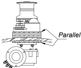
Le modèle PROGRESS est constitué de pièces sur le pont, poupée (274), barbotin (512) et base (518), et de pièces sous le pont moteur électrique (315) et transmission (305). Séparer les éléments sur le pont des éléments sous le pont. Dévisser et retirer les écrous (227) des tiges filetées (225).
