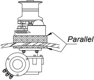
Le modèle PROGRESS TWO est constitué de pièces sur le pont , poupée, barbotin et base , et de pièces sous le pont moteur électrique et transmission. Séparer les éléments sur le pont des éléments sous le pont . Dévisser et retirer les écrous des tiges filetées.
